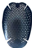
Foto protettore: SPALLA 473 0 E00B SAFE TECH Livello 2 tipo A, EN 1621-1:2012, CE. LATO INTERNO: lato liscio deve essere a contatto con pelle. TAGLIE: Tutte le taglie
