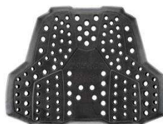
Foto protettore: PETTO SC1-CP4 SAS-TEC Livello 1 tipo A, EN 1621-3:2018, CE. LATO ESTERNO: lato texturizzato deve essere rivolto verso l'esterno della maglia. TAGLIE: da XS/S a M/L
